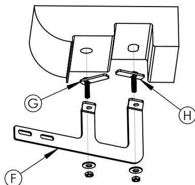
4- Retirar os tampões da caixa de ar na parte traseira do veículo e posicionar os pontaletes "G" e "H".
