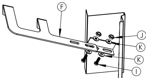
6- Fixar os estribos "A" e "B" nos suportes com auxílio dos parafusos "I", arruelas "K" e porcas "J" cuidando para que os suportes fiquem por dentro das cantoneiras dos estribos, conforme figura ao lado.
