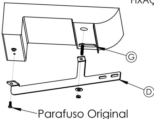
1- Posicionar os estribos na lateral no veículo para identificar onde serão fixados os suportes.
